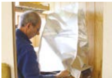
L'artisan utilise une technologie non chimique pour traiter les parasites du bois : l'anoxie. Il enferme pendant 3 semaines, dans une pièce à 21°, le meuble isolé dans une poche étanchéifiée, contenant un sachet qui absorbe l'oxygène.
